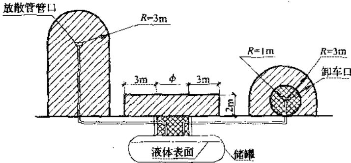
图 C.0.7 埋地 LPG 储罐爆炸危险区域划分
