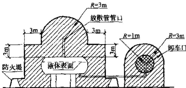
图 C.0.8 地上 LPG 储罐爆炸危险区域划分
