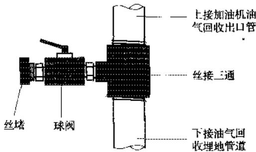
图 1 液阻和系统密闭性检测口示意
