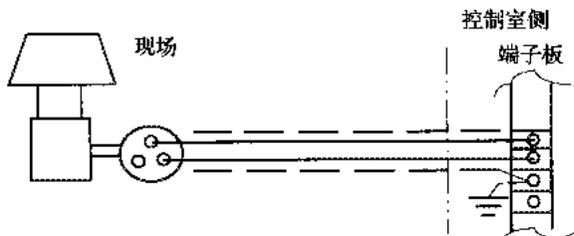
图 2 电缆屏蔽单端接地示意
