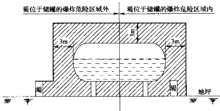
图 C.0.16-1 地上 LNG 储罐的爆炸危险区域划分
