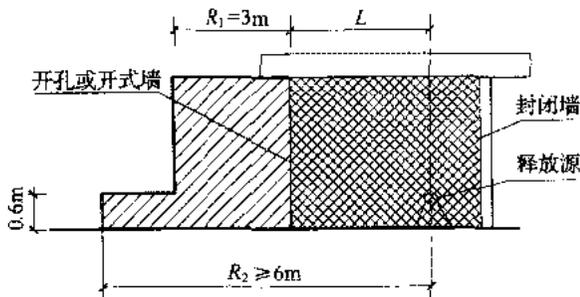
图 C.0.10 LPG 压缩机、泵、法兰、阀门或类似附件的
