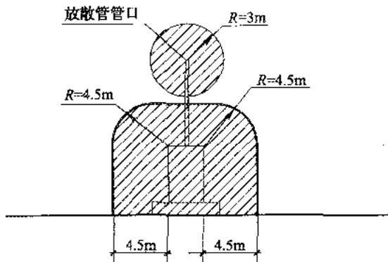
图 C.0.11 室外或棚内储气瓶(组)、储气井、车载储气瓶的
