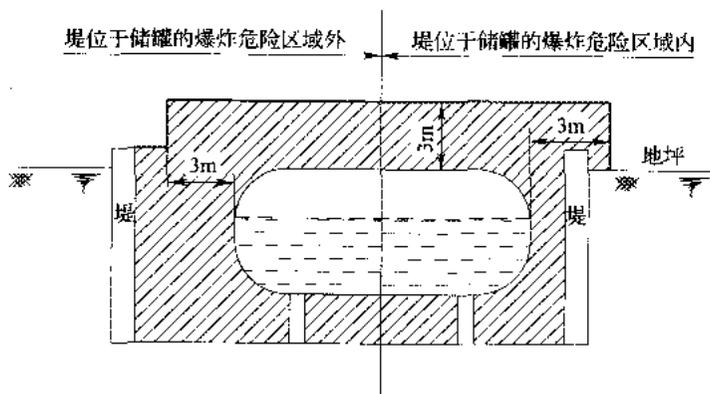
图 C.0.16-3 地下 LNG 储罐的爆炸危险区域划分
